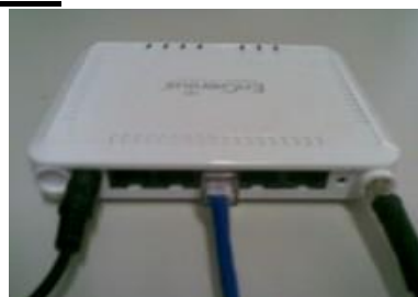
Fonte de Energia | Cabo de Rede | Cabo Pig-tail
